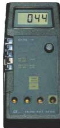
Wattmeter sind Messinstrumente, welche gleichzeitig Strom und Spannung messen und direkt die elektrische Leistung (Produkt aus Spannung  $\times$  Strom) anzeigen.
