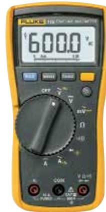
Digitale Multimeter sind Vielfachmessinstrumente mit Ziffernanzeige, welche neben Spannungs-, Strom- und Widerstandsmessung oft auch Kapazitäts- und Frequenzmessung ermöglichen.
