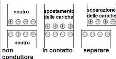
Tramite attrito o separazione di materiali isolanti, ma anche tramite agitazione di fluidi non conduttori si formano delle cariche con tensioni elevate. Questa elettricità statica è generalmente indesiderata.
